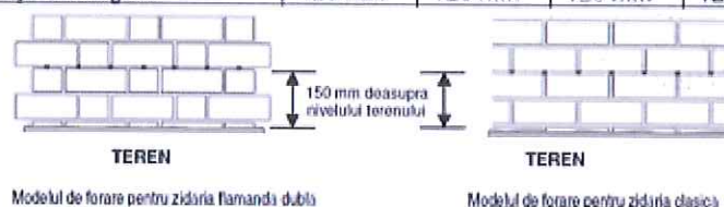
Fig. 22 – Corespondența dintre adâncimea găurilor și grosimea peretelui. Poziție forare găuri
